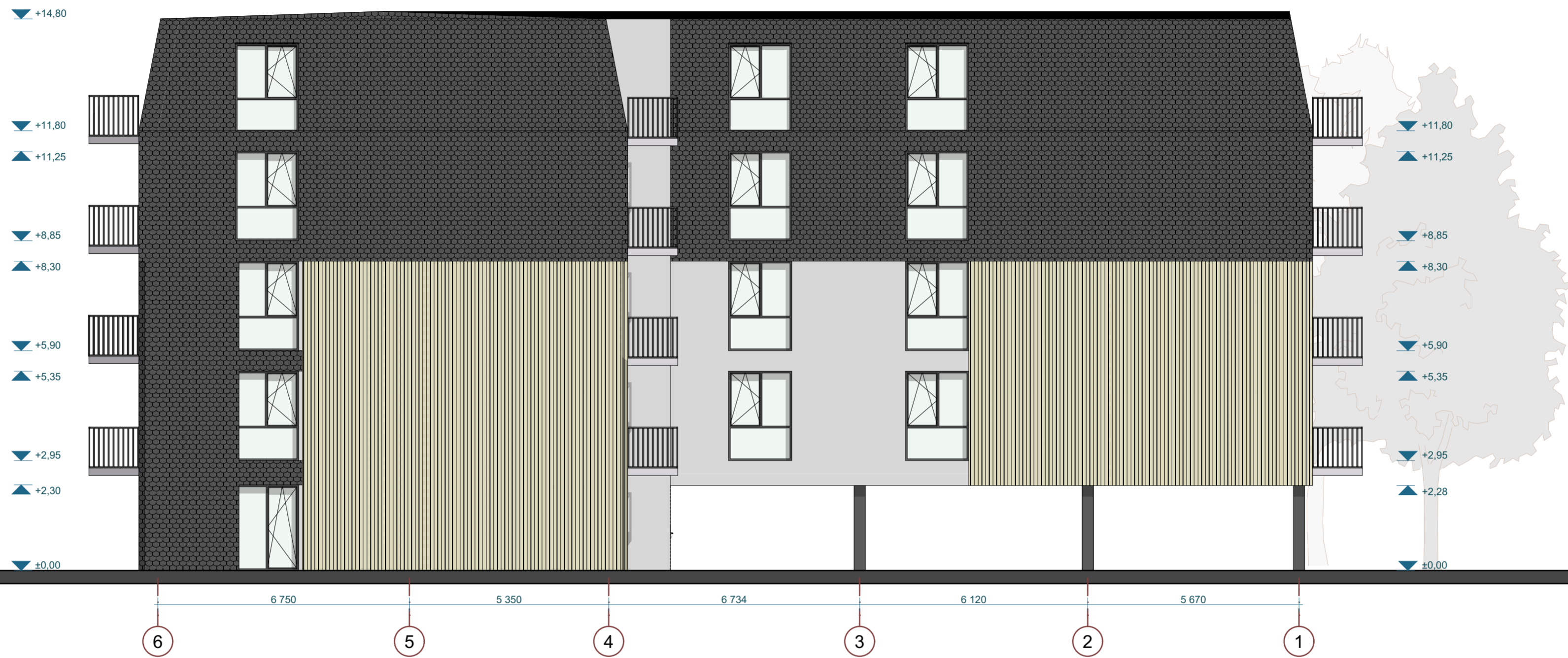
FASADAS TARP AŠIŲ 6-1, M 1:100
