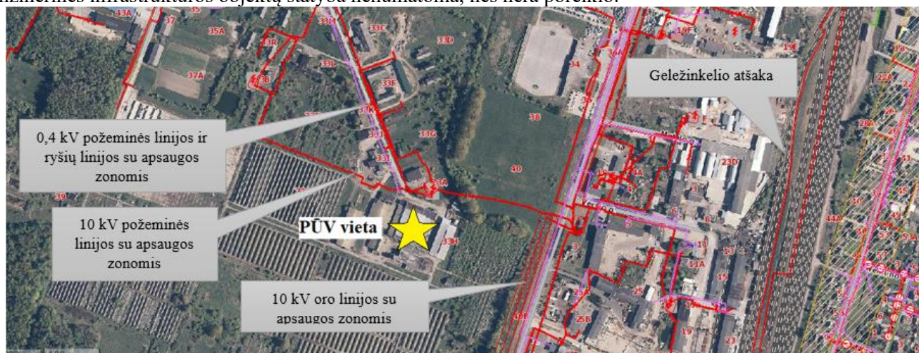
27.6. Pav. PŪV žemės sklypo išsidėstymas inžinerinės infrastruktūros paskirties teritorijų atžvilgiu
