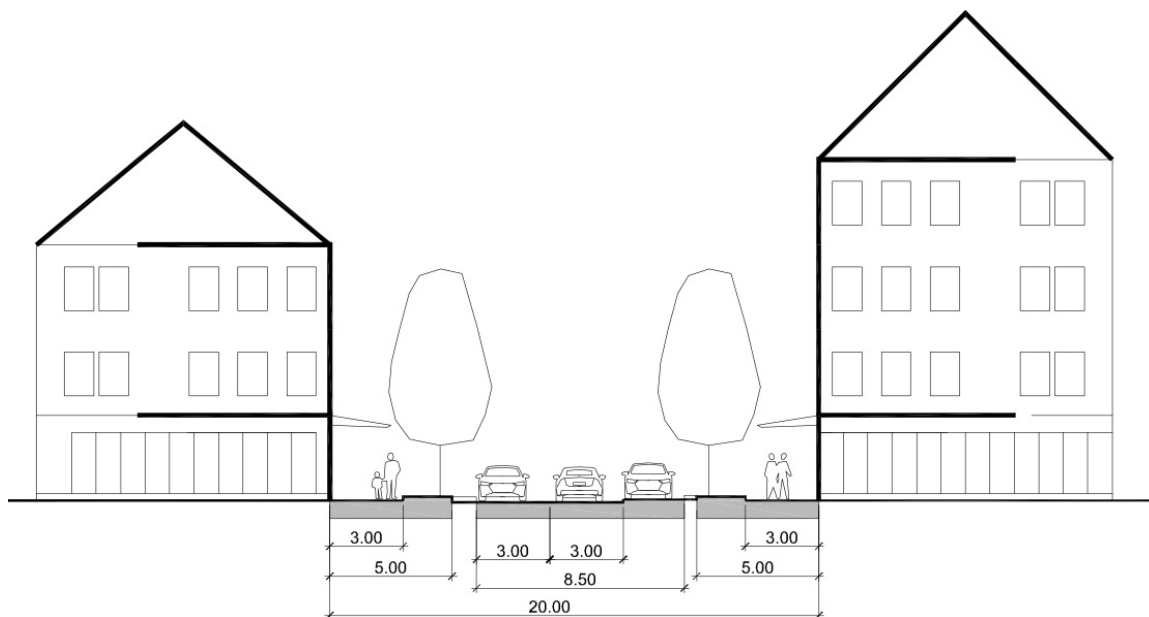
3.8.5 pav. Skersinis gatvės profilis, rekomenduojamas D kategorijos D-2 tipo gatvėms, esančioms centrų ir mišrioje gyvenamojoje zonoje (CG, GM), taip pat D-1 tipo gatvėms, esančioms gyvenamosiose zonose GG
